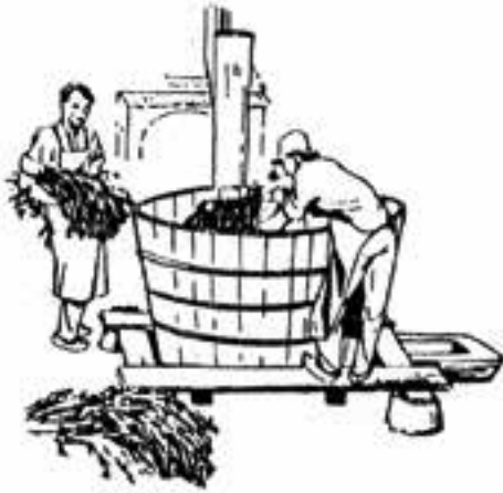
3: Einbringen von Wachholder als Filter für die Bierwürze in den Maischbottich
