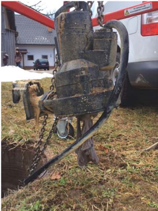
Foto: ABA Magdalensberg, durch Wäsche verstopfte Abwasserpumpe
